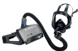
Masque complet à ventilation assisté avec filtre TM3P : uniquement lors d'interventions pour un empoussièremment inférieur à 60 fois la Valeur limite d'exposition professionnelle (VLEP : 10 fibres par litre d'air)
