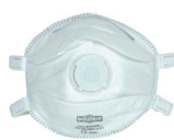
½ masque FFP3 : uniquement pour des interventions de moins de 15 minutes et pour un empoussièremment inférieur à 10 fibres par litre d'air
